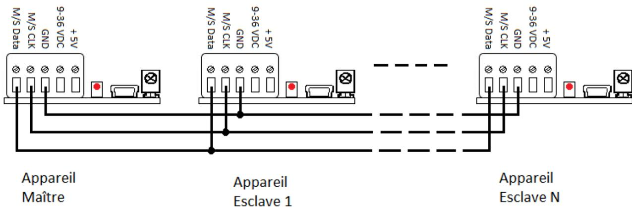
Les interfaces configurées en esclave suivront rigoureusement l'horloge, les déclenchements et les informations provenant de l'interface maître. Une seule interface maître est possible.
