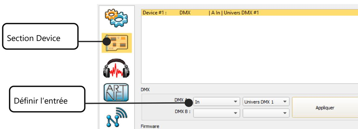
Ensuite il est possible à partir du logiciel d'enregistrer un signal DMX et créer une nouvelle scène contenant l'enregistrement complet du signal d'entrée.
