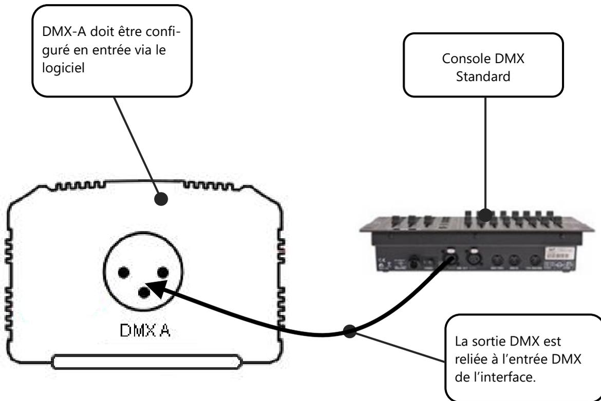
La ligne DMX doit être définie en Entrée dans la fenêtre des options du logiciel. Pour accéder à cette fenêtre cliquez dans le menu logiciel: Outils > Options puis cliquez sur la section « Device » comme suivant:
